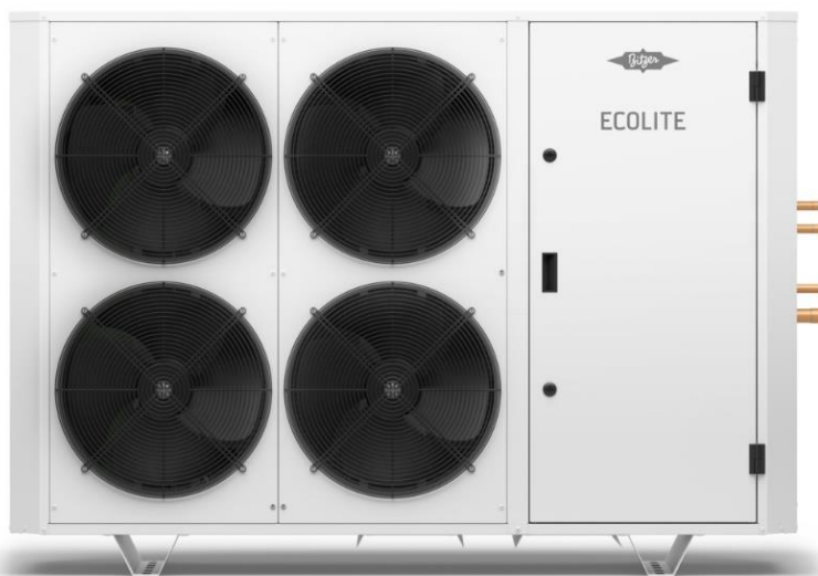
Bild: Verflüssigungssatz ECOLITE LHL7EF – ausgestattet mit IQ MODUL CM-RC-02 mit Erweiterungskarte, VARIPACK Frequenzumrichter und mechanischer Leistungsregelung CR
